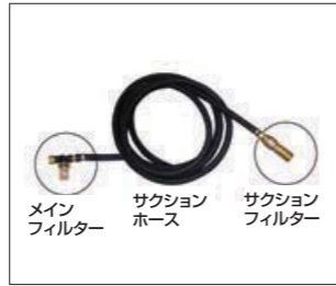
自吸用ホース(サクションホース) ため水を利用する際に使用するホースです。必ずメインフィルター(本体取付側)と、先端フィルター(ため水側)の2種類を使用してください。
