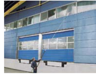
伸縮ランス 足場などを設けずに高い場所の洗浄が効率良く行えます。伸縮ランスのガンに、延長高圧ホースを取り付け使用します。
