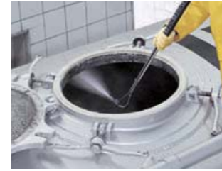
フレキシブルランス ノズル先端の角度を20°から140°まで変えることができ、通常ノズルでは届きにくい側面や裏面などの洗浄を効率的に行えます。
