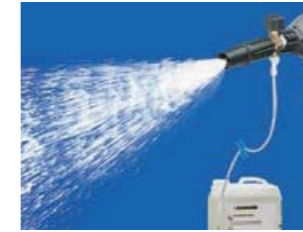
フォームノズルダイレクト 洗浄剤の容器からダイレクトに供給できるので、大量に散布することが可能です。部分泡洗浄や腐食性の薬剤散布に使用できます。
